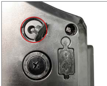
Presa di ricarica batteria
