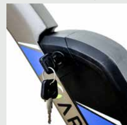
Telaio idroformato con batteria integrata
